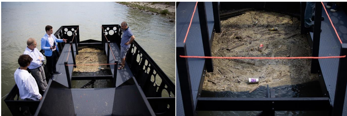
19. ábra: A hulladéktérben már nem sokkal a kihelyezés után elkezdett gyűlni a hulladék. Az ürítési munkák során a hozzáférés kényelmes és biztosított.
